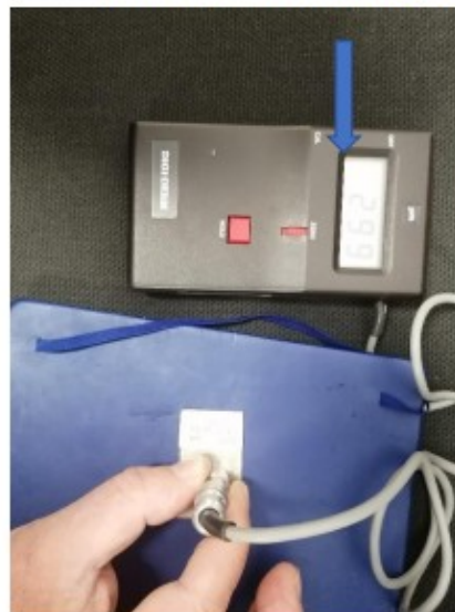
Slika 2. Kontrola ispravnosti ultrazvučnog mjerača na etalonu nakon mjerenja
